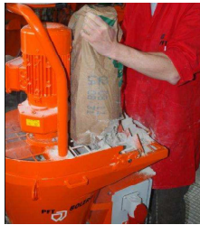
Fig. 35: Fill in bagged material
